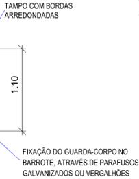
FIXAÇÃO DO GUARDA-CORPO NO BARROTE, ATRAVÉS DE PARAFUSOS GALVANIZADOS OU VERGALHÕES
