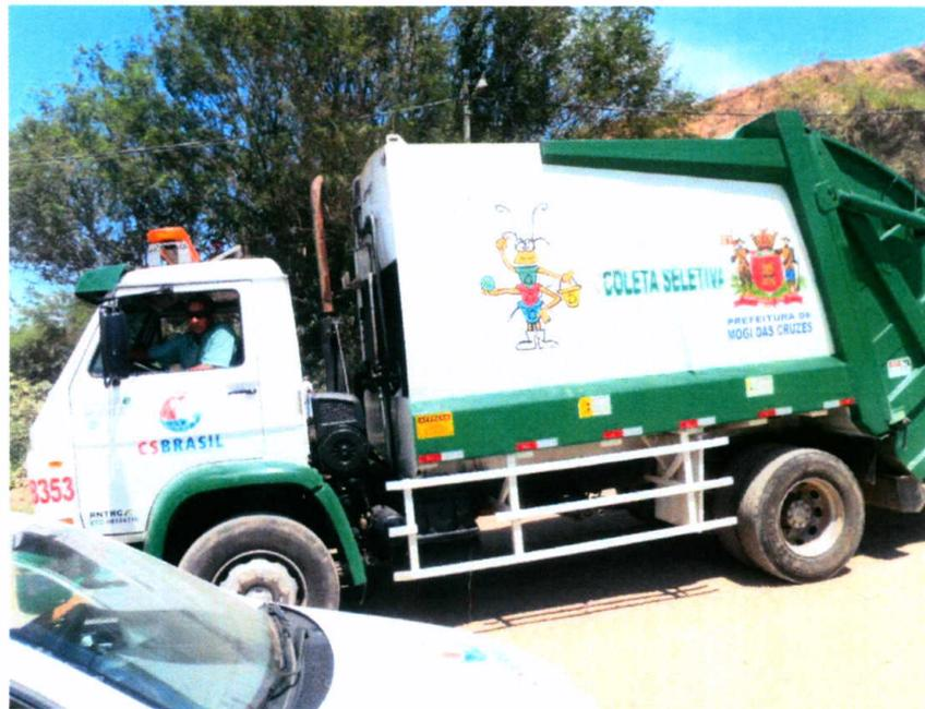
**Foto 4 Compactador utilizado na coleta seletiva**
